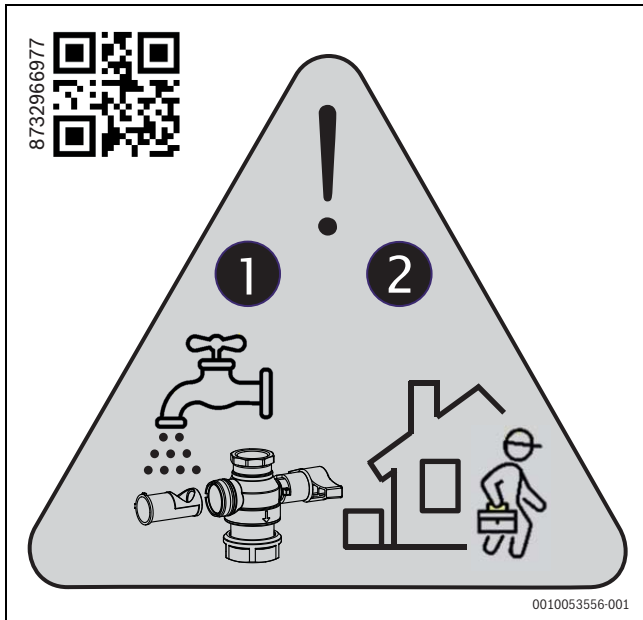
Bild 13 Partikelfilter nach Wartung reinigen
