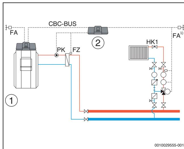
Fig. 34 Variante 2: sottostazione con compensazione dispersioni termiche tramite FZ, limitazione di potenza
