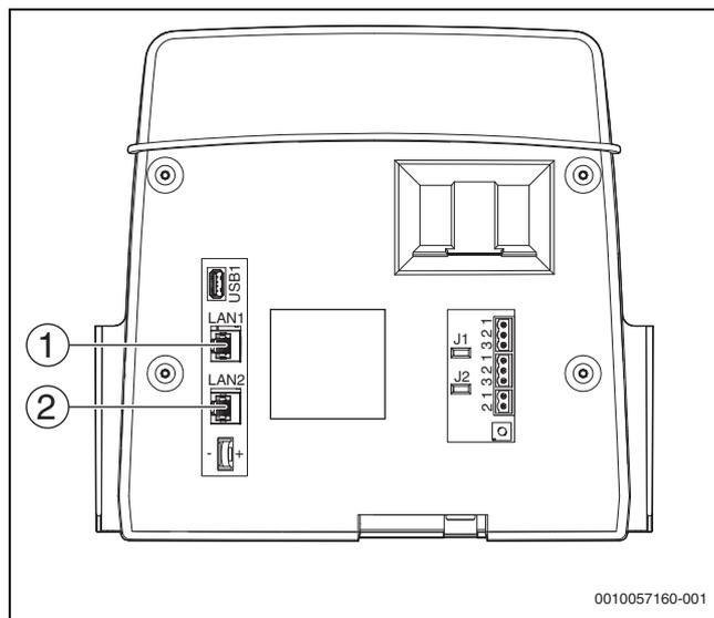
Fig. 45 Collegamento per LAN1 e LAN2
