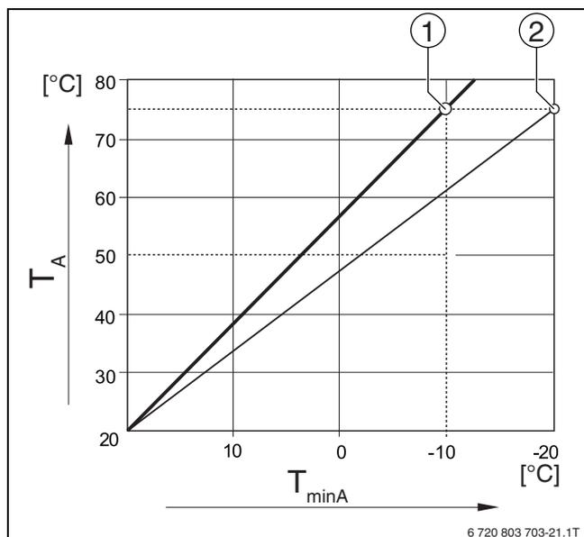
Fig. 27 Impostazione della curva termocaratteristica di riscaldamento: impostazione della pendenza tramite temperatura di progetto e temperatura esterna minima
