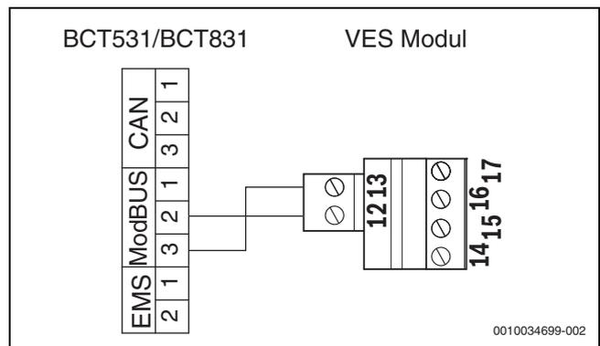
Fig. 37 Collegamento del termoregolatore al modulo Modulo VES
