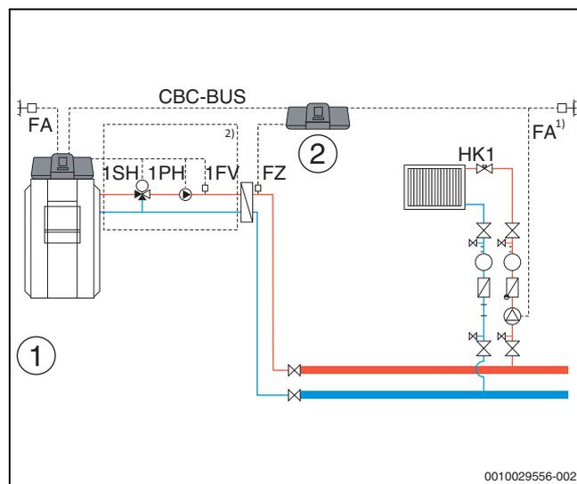
Fig. 35 Variante 3: sottostazione con funzione di pre-miscelazione, compensazione dispersioni termiche tramite FZ, limitazione di potenza e funzionamento in riscaldamento con comunicazione interrotta
