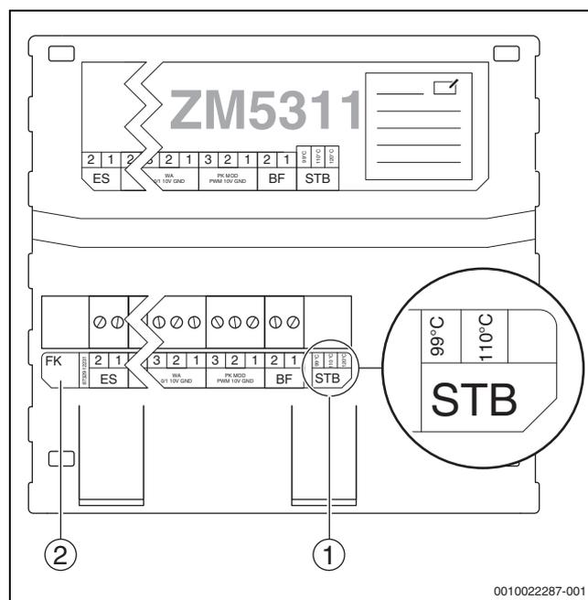
Fig. 24 Limitatore temperatura di sicurezza elettronico con ZM5311
