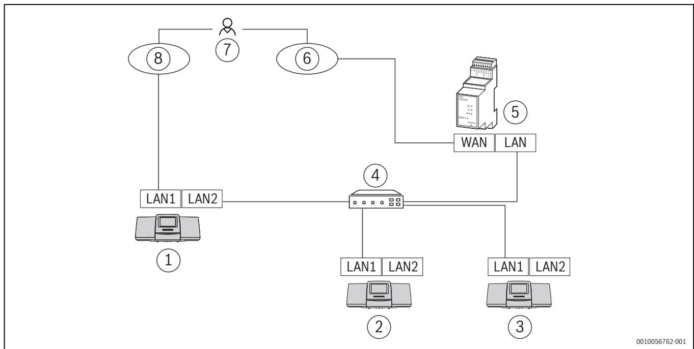
Fig. 47 Esempio di connessione di termoregolatori con accesso remoto e sistema di automazione dell'edificio
