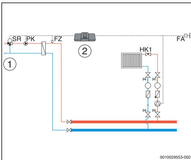
Fig. 32 Variante 3: fonte di calore fornita da terzi senza circolatore di alimentazione, limitazione di potenza, funzione di pre-miscelazione, compensazione dispersioni termiche tramite FZ
