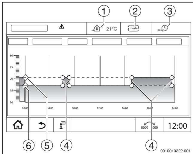
Fig. 41 Modificare Funzionamento in attenuazione automatico nel programma orario
