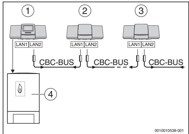
Fig. 46 Esempio di connessione con più termoregolatori
