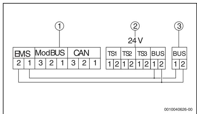
Fig. 5 Collegamento elettrico
