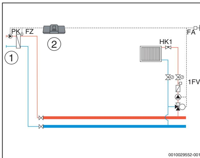
Fig. 31 Variante 2: fonte di calore fornita da terzi senza un circolatore di alimentazione, limitazione di potenza e compensazione dispersioni termiche tramite FZ
