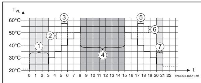
Fig. 44 Asciugatura massetto
