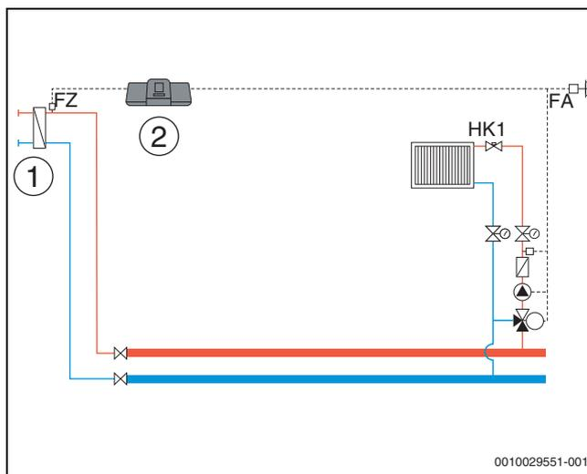
Fig. 30 Variante 1: fonte di calore fornita da terzi con un circolatore di alimentazione, limitazione di potenza e compensazione dispersioni termiche tramite FZ
