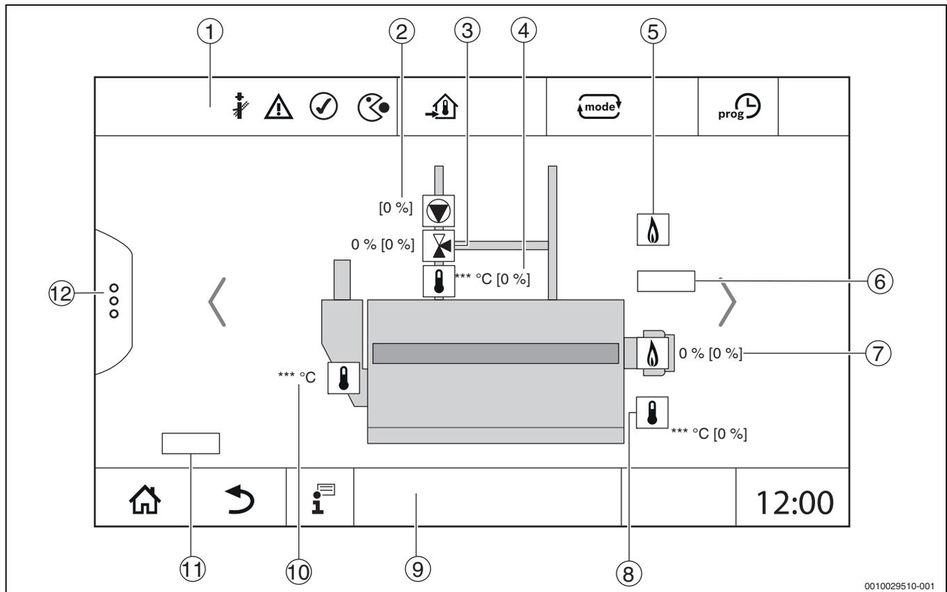
Fig. 12 Visualizzazione Generazione di calore (esempio)
