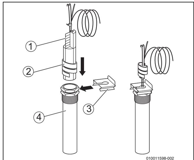
Fig. 7 Inserimento della spirale di plastica nel pozzetto ad immersione@@
