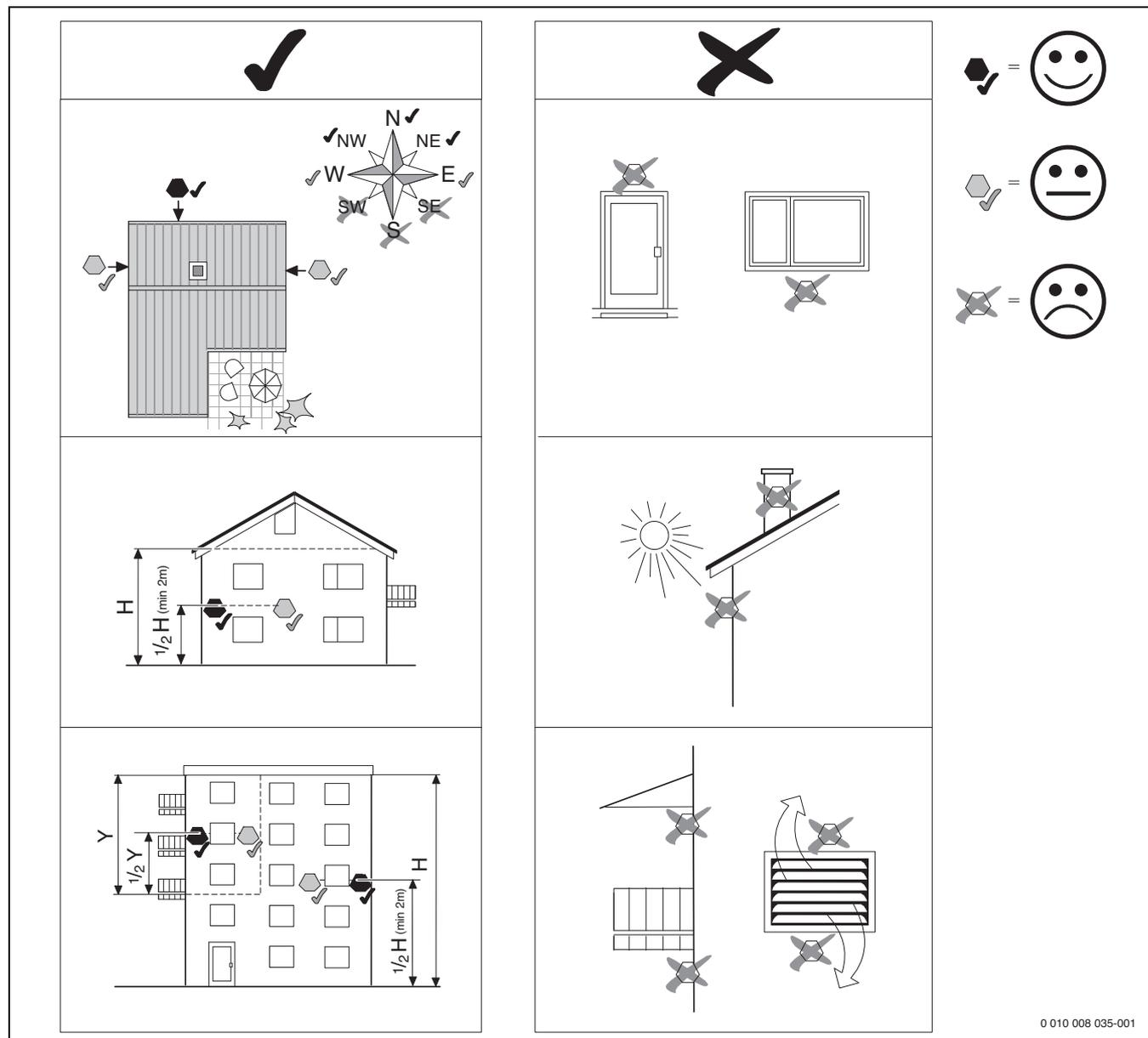
Fig. 8 Montaggio della sonda esterna
