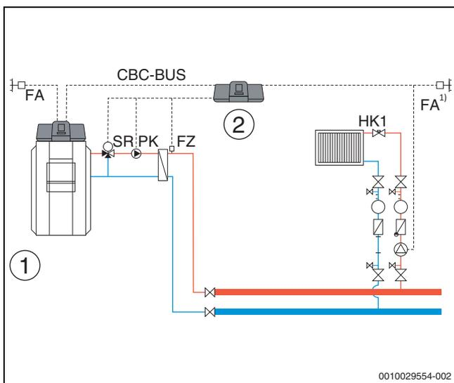
Fig. 33 Variante 1: sottostazione con funzione di pre-miscelazione, compensazione dispersioni termiche tramite FZ, limitazione di potenza
