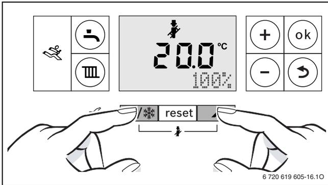
Bild 61 100 % (maximale Nennwärmeleistung Warmwasser)
