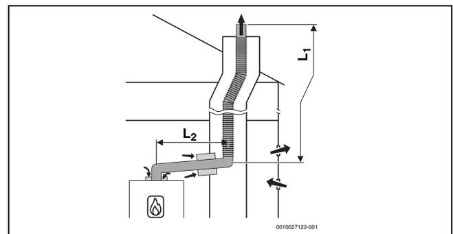
Bild 22 Flexible Abgasführung im Schacht nach B<sub>23p</sub>/B<sub>53p</sub> mit raumluftabhängiger Luftzufuhr am Gerät und konzentrischem Verbindungsstück zwischen Aufstellraum und Schacht
