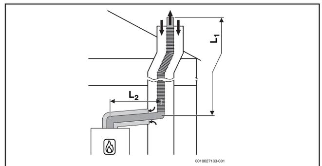
Bild 20 Flexible Abgasführung nach C<sub>93x</sub> im Schacht und konzentrische Luft-Abgas-Führung im Aufstellraum
