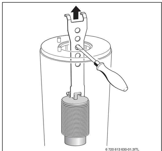
Bild 68 Unteren Verdrängungskörper herausnehmen
