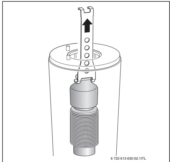
Bild 67 Oberen Verdrängungskörper herausnehmen
