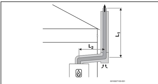
Bild 18 Konzentrische Luft-Abgas-Führung nach C<sub>53x</sub> an der Außenwand
