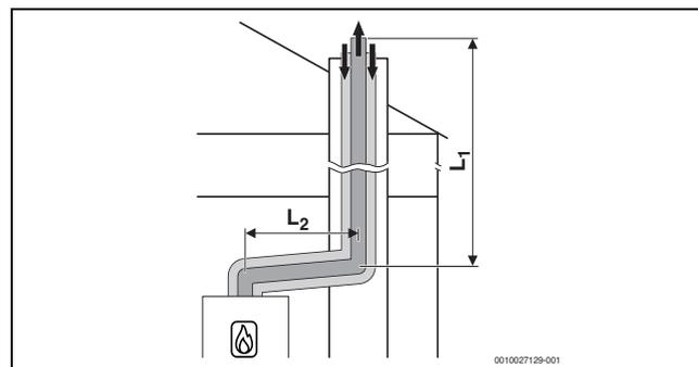
Bild 11 Konzentrische Luft-Abgas-Führung nach C<sub>33x</sub> im Schacht
