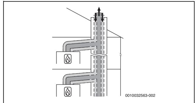
Bild 25 Mehrfachbelegung nach C<sub>(10)3x</sub> mit konzentrischer Luft-Abgas-Führung im Aufstellraum
