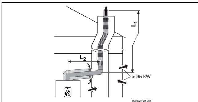
Bild 24 Flexible Abgasführung im Schacht nach B<sub>33</sub> mit raumluftabhängiger Luftzufuhr über die konzentrische Luft-Abgas-Führung im Aufstellraum
