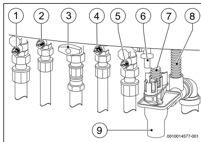
Bild 36 Gas- und wasserseitige Anschlüsse (Zubehör)
