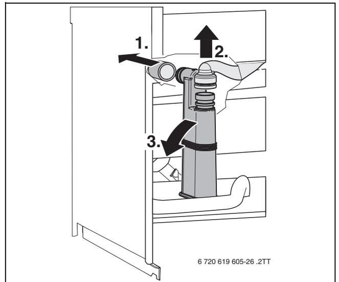
Bild 72 Kondensatsiphon ausbauen
