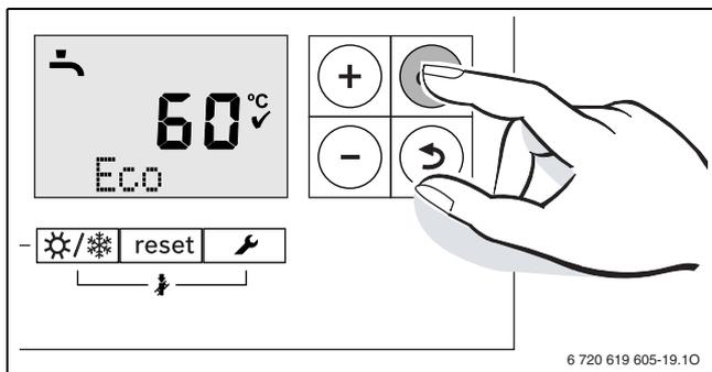
Bild 48 Anzeige eco-Betrieb bestätigen
