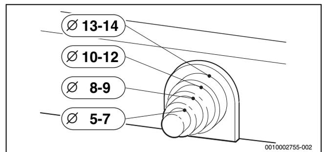
Bild 40 Zugentlastung an Kabeldurchmesser anpassen
