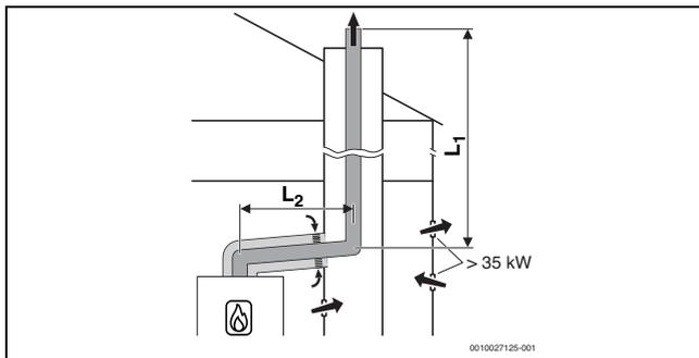
Bild 23 Starre Abgasführung im Schacht nach B<sub>33</sub> mit raumluftabhängiger Luftzufuhr über die konzentrische Luft-Abgas-Führung im Aufstellraum
