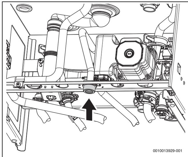
Bild 30 Anschluss externes Ausdehnungsgefäß
