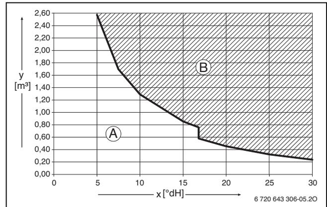
Bild 29 Anforderungen an Füll- und Ergänzungswasser Geräte < 50 kW
