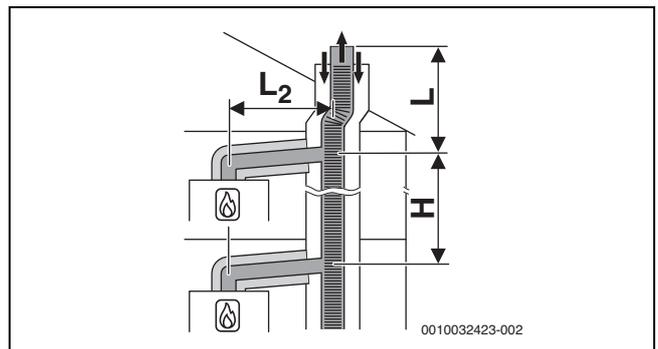
Bild 28 Mehrfachbelegung nach C<sub>(14)3x</sub> mit kollektiver flexibler Abgasableitung und konzentrischer Luft-Abgas-Führung im Aufstellraum
