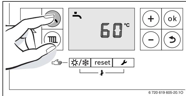
Bild 49 Anzeige Warmwassertemperatur
