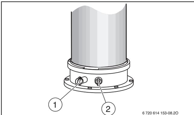
Bild 62 Abgassensstutzen und Verbrennungsluft-Messstutzen
