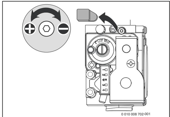
Bild 58 Plombe entfernen
