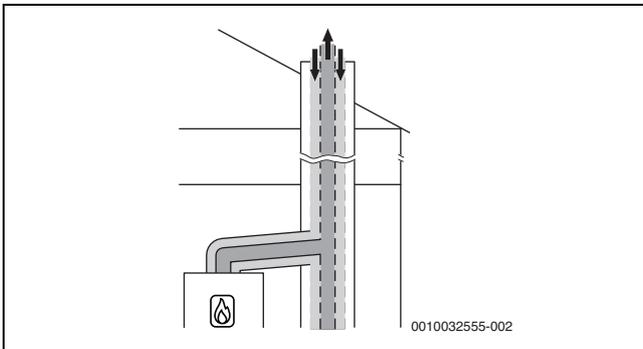
Bild 13 Konzentrische Luft-Abgas-Führung nach C<sub>43x</sub> im Aufstellraum
