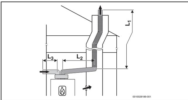
Bild 17 Flexible Abgasführung nach C<sub>53</sub> im Schacht und Luft-Abgas-Führung mit getrennten Rohren für Luftzufuhr und Abgasableitung im Aufstellraum
