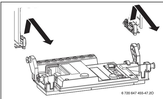
Bild 83 Steuergerät aushängen
