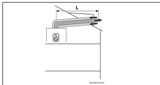
Bild 9 Horizontale konzentrische Luft-Abgas-Führung nach C<sub>13x</sub> über das Dach
