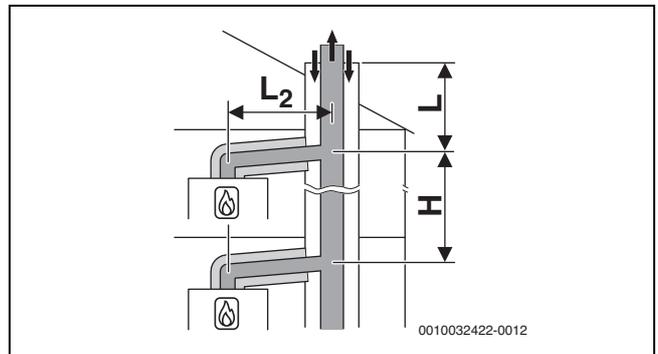
Bild 27 Mehrfachbelegung nach C<sub>(14)3x</sub> mit kollektiver starrer Abgasführung und konzentrischer Luft-Abgas-Führung im Aufstellraum
