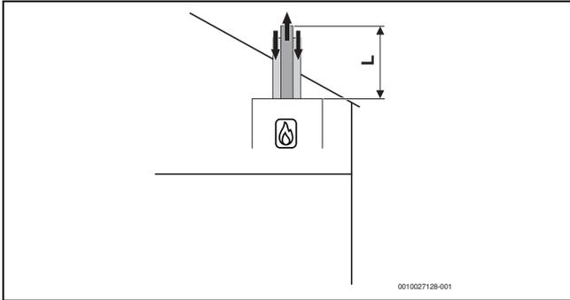
Bild 12 Vertikale konzentrische Luft-Abgas-Führung nach C<sub>33x</sub>
