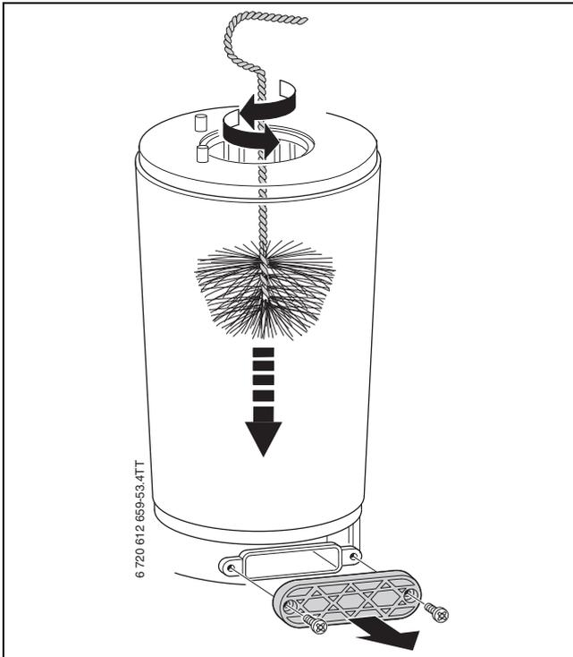
Bild 69 Wärmeblock reinigen
