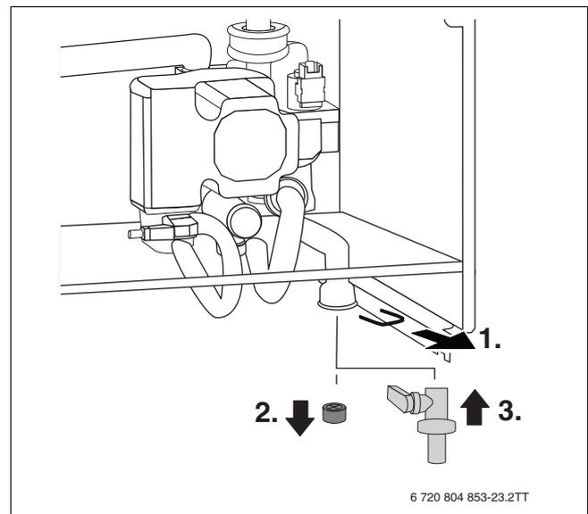
Bild 34 Füll- und Entleerhahn montieren
