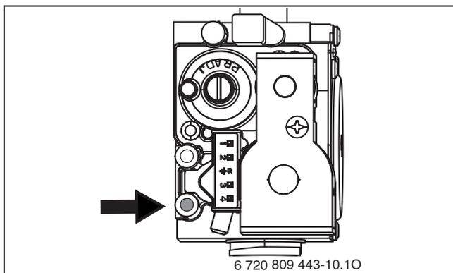
Bild 60 Messstutzen für Gas-Anschlussdruck
