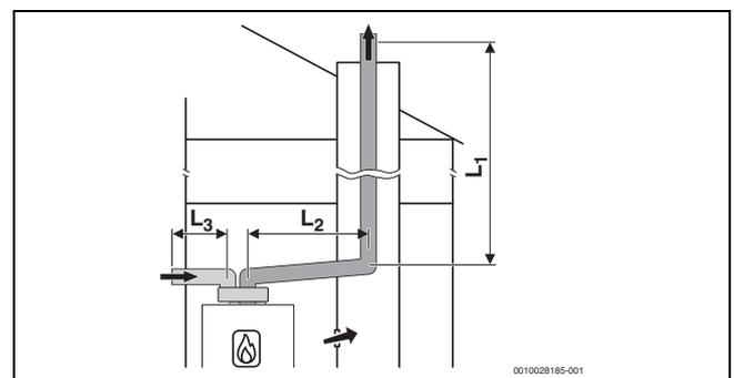
Bild 15 Starre Abgasführung nach C<sub>53</sub> im Schacht und Luft-Abgas-Führung mit getrennten Rohren für Luftzufuhr und Abgasableitung im Aufstellraum
