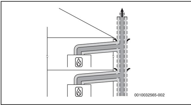
Bild 26 Mehrfachbelegung nach C<sub>(12)3x</sub> mit konzentrischer Luft-Abgas-Führung im Aufstellraum
