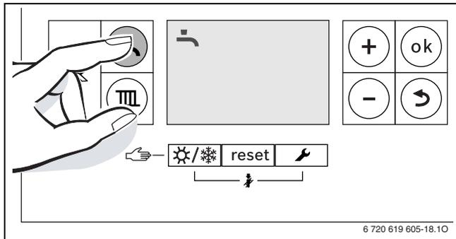
Bild 47 Anzeige Warmwasserbetrieb
