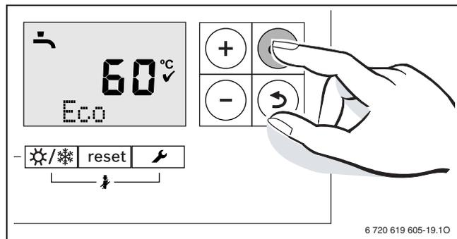
Bild 50 Anzeige Warmwassertemperatur bestätigen
