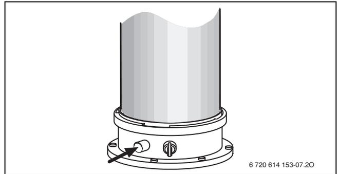
Bild 57 Abgasmessstutzen
