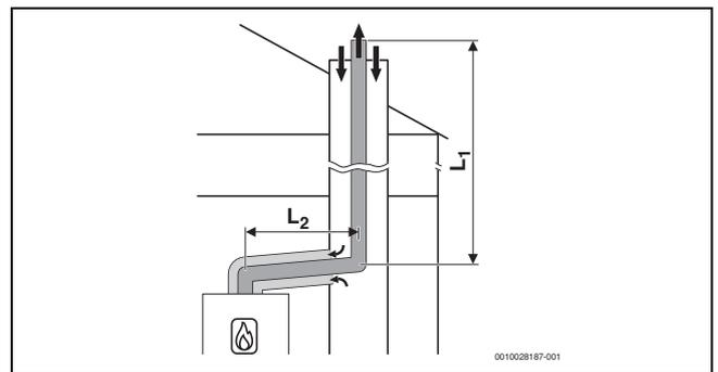
Bild 19 Starre Abgasführung nach C<sub>93x</sub> im Schacht und konzentrische Luft-Abgas-Führung im Aufstellraum
