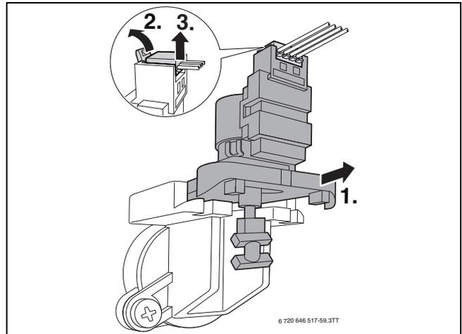
Bild 75 Motor des 3-Wege-Ventils ausbauen
