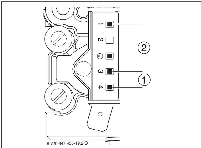
Bild 77 Messstellen an der Gasarmatur
