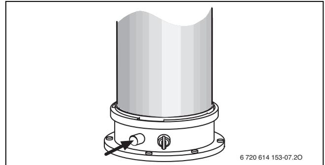
Bild 55 Abgasmessstutzen
