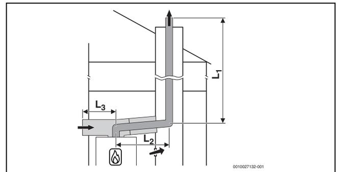
Bild 14 Starre Abgasführung nach C<sub>53x</sub> im Schacht und Luft-Abgas-Führung mit separater Luftzufuhr und konzentrischer Abgasableitung im Aufstellraum
