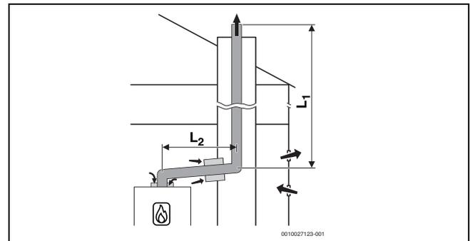
Bild 21 Starre Abgasführung im Schacht nach B<sub>23p</sub>/B<sub>53p</sub> mit raumluftabhängiger Luftzufuhr am Gerät und konzentrischem Verbindungsstück zwischen Aufstellraum und Schacht
