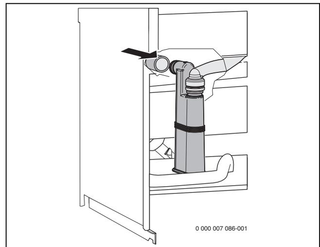
Bild 33 Schlauch am Kondensatsiphon montieren
