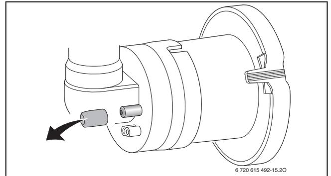
Bild 63 Messstutzen an der Mischeinrichtung
