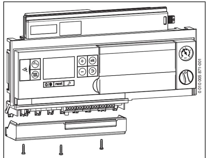
Bild 80 Abdeckung entfernen
