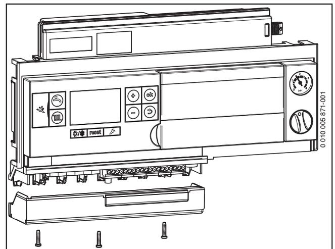
Bild 39 Abdeckung entfernen
