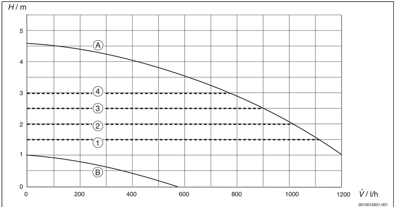
Bild 90 Pumpenkennfelder und Pumpenkennlinien
