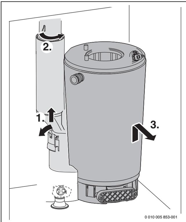
Bild 86 Wärmeblock ausbauen
