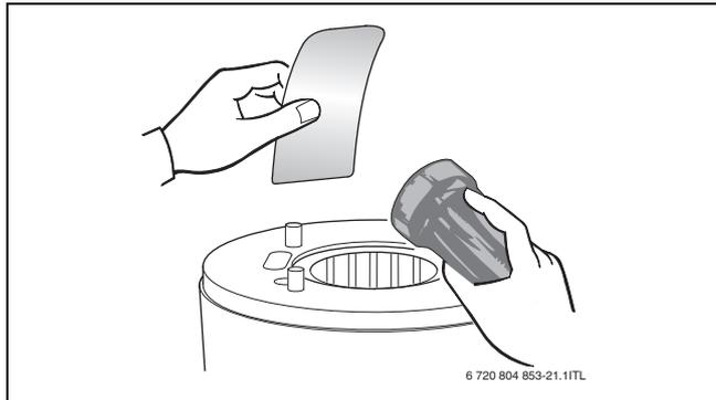
Fig. 68 Controllo della presenza di residui nello scambiatore primario
