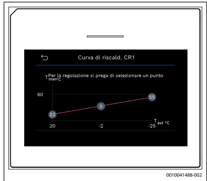
Fig. 1 Schermata iniziale per l'impostazione della curva termocaratteristica di riscaldamento per il tipo di regolazione in funzione della temperatura esterna con punto base (e punto di comfort)
