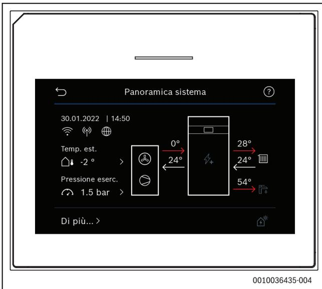
Fig. 11 Panoramica del sistema della pompa di calore
